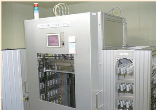
5日目のDOを測定しその差からBODを算出
